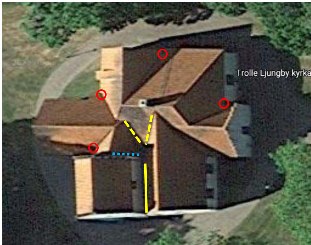
Figur 1. Gula markeringar visar rännalor som behövs. Helt dragen linje visar rännalor mellan södra tillbyggnaden och klocktornet. Streckade linjer visar rännalorna på långhusets södra takfall. Punktlinje visar rännalor mot klocktornet. Röda cirkel visar plats där rötskadad brädbotten ersatts.
