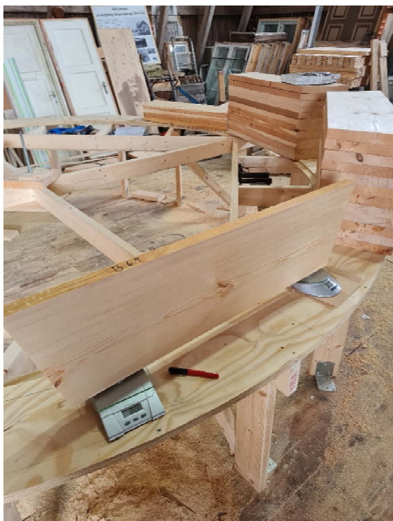
Vattenhjulet under konstruktion på verkstad. Foto: Gunnar Zackrisson.
