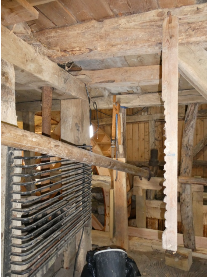
Pådragarmens nya placering invid vattenhjulet och den invändiga pådragssluckan.
