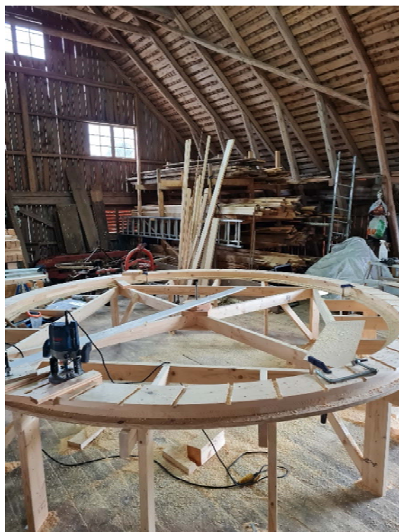
Vattenhjulet under konstruktion på verkstad. Foto: Gunnar Zackrisson.
