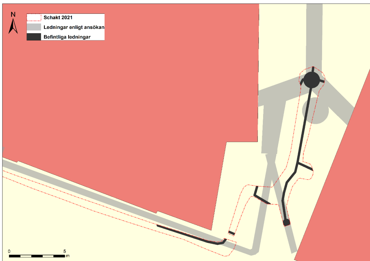
Figur 7. Utdrag ur fastighetskartan med de planerade schaktsträckorna i grå färg och de faktiska schaktningen streckat i rött. ©Lantmäteriet.
