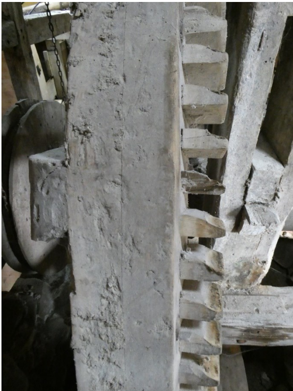
Skadade kuggar på stora kronhjulet.
