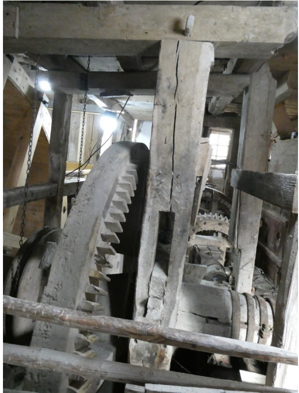
Lättverket, horisontell bjälke direkt ovanhjulstocken. Stora kronhjulet.
