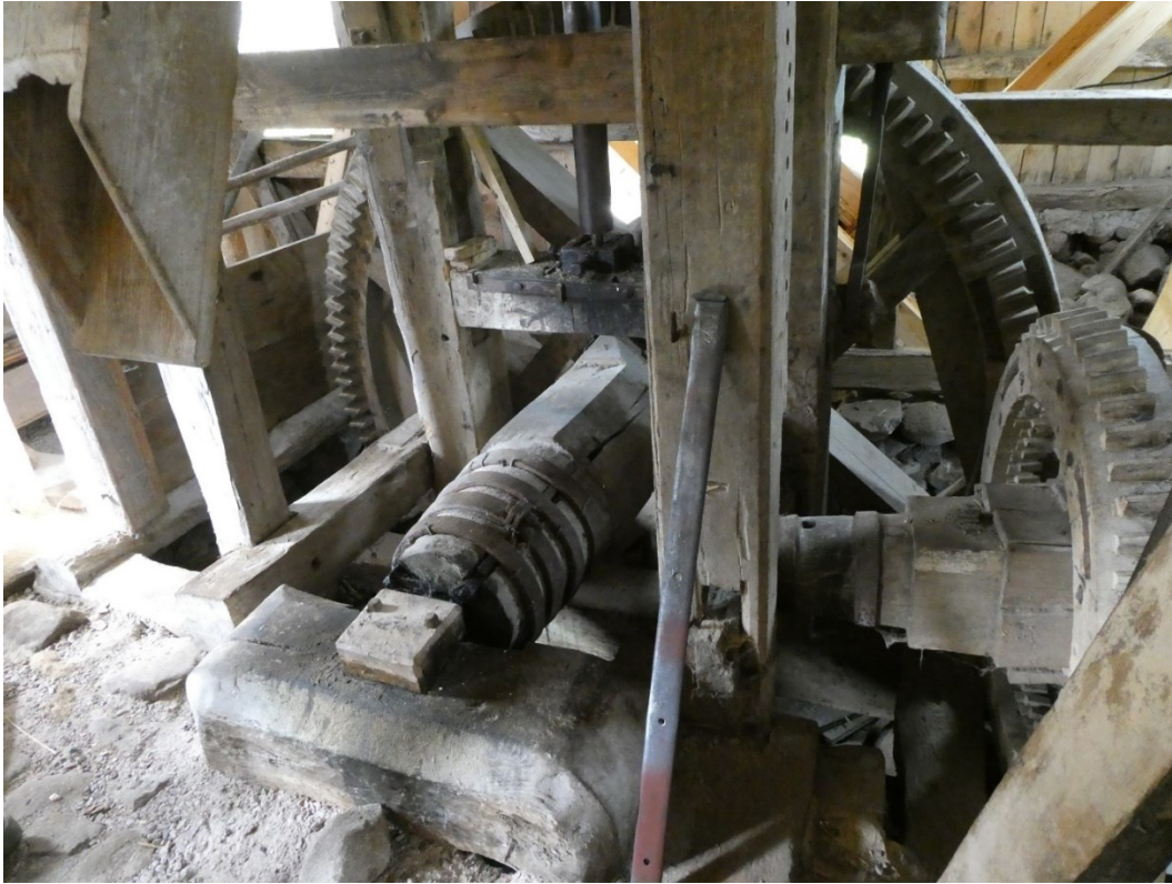
Smidesjärnet som ska monteras för att stabilisera lättverket.
