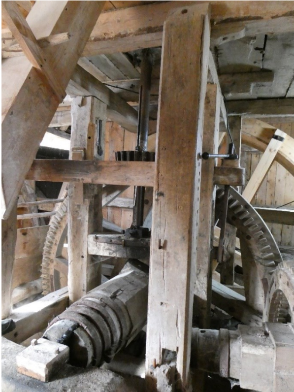
Lättverket, horisontell bjälke direkt ovanhjulstocken. Stora kronhjulet.
