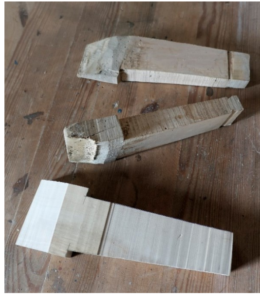
Stora kronhjulet är kilat med träkilar och justerat. Höger: Ny kugge längst ner i bild. De två övre i bild är uttjänta, den i mitten är sprucken
