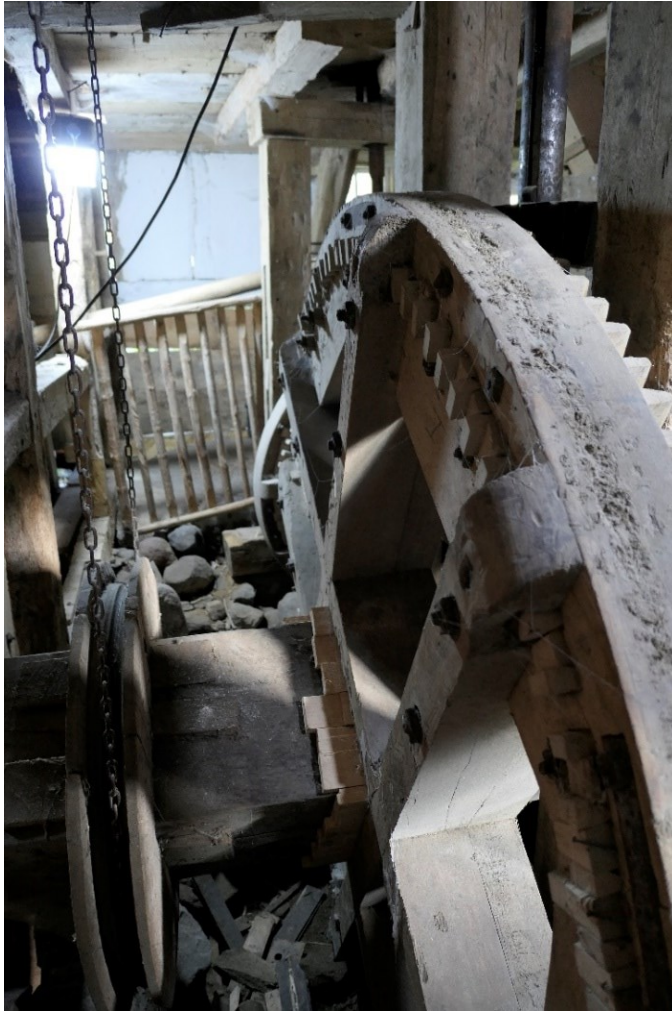
Stora kronhjulet är kilat med träkilar och justerat. Höger: Ny kugge längst ner i bild. De två övre i bild är uttjänta, den i mitten är sprucken
