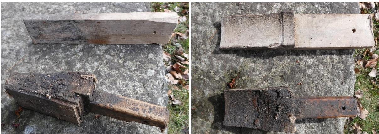
Uppnött sprons samt kil. Notera spronsen på vänstra bilden att man lagt på skikt för att utöka tjockleken efter hand då den nötts. Den övre i bild är från det stillastående stenparet och den nedre är en sprons som hittades i kvarnen. Den övre användes som förebild vid nytillverkning.
