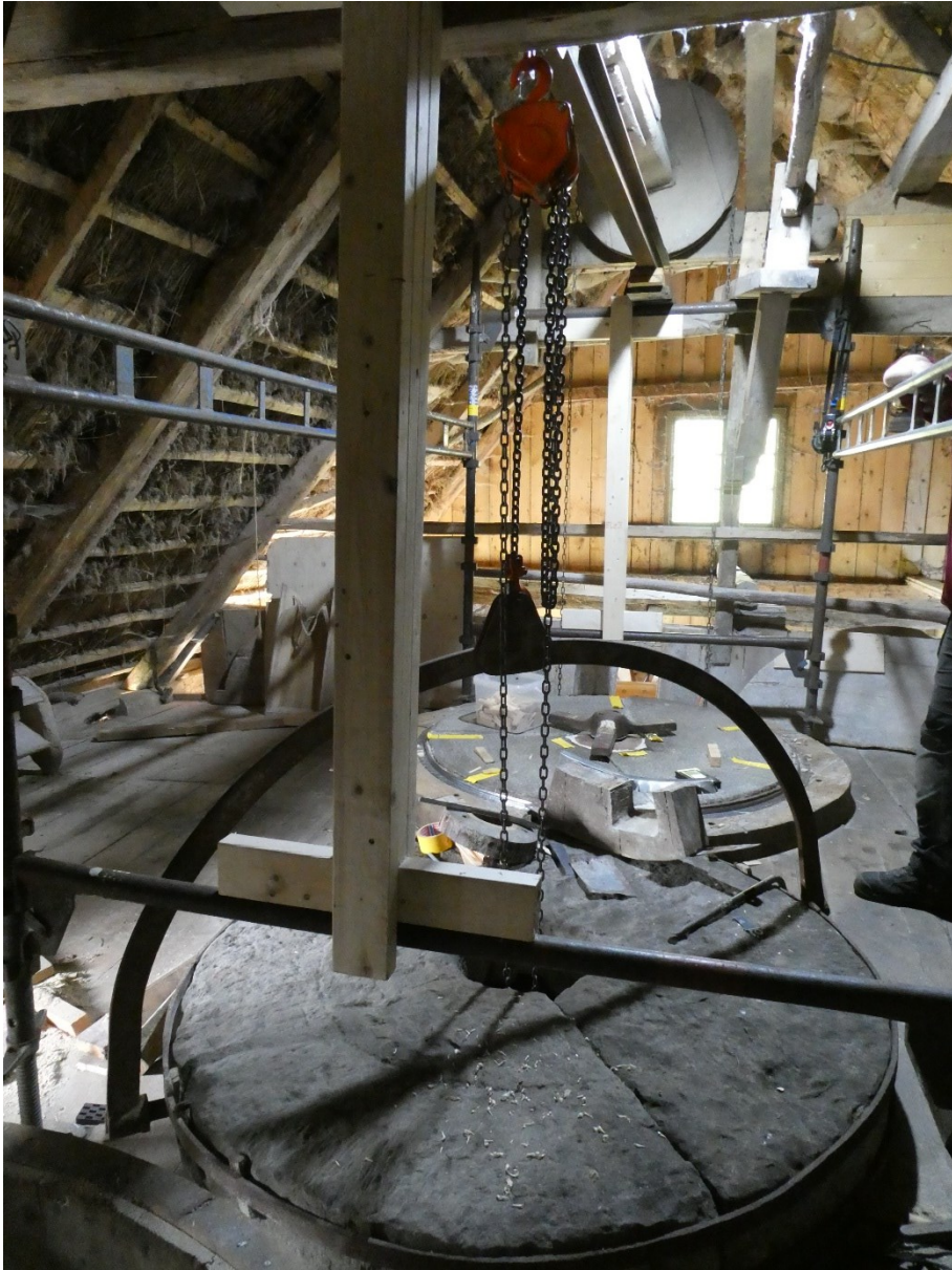
Stenparet i drift där löparen (övre stenen) har lyfts av, läparen syns i bildens framkant.
