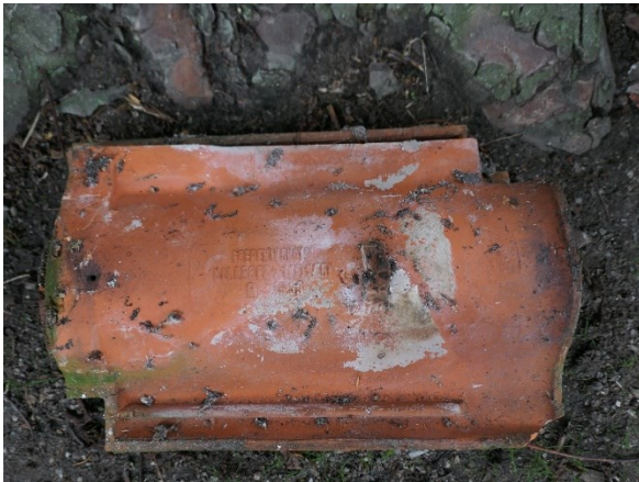
Vänster: Takpannor som fanns på det aktuella murparitet. Fredriksholm Hilleröd tegelverk, G 1959. Höger: Återvunna takpannor av samma fabrikat lades på det ommurade partiet.
