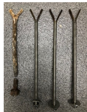
Lykta med rengjord armatursockel, norra korsarmen. Lykta med ny armatursockel. Återstod att ta bort tape och måla in skruvar vid fotograferingstillfället. Höger: gammalt och nya stänger för infästning av lyktan mot väster.
