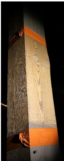
Klostrets vind. Provytor isblästring, ångtvätt och slipning.
