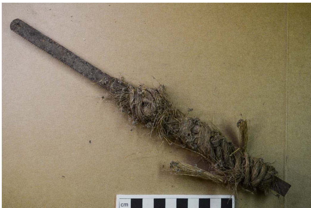
En med jutesnöre hastigt skaftad fintandad såg för metall. Troligtvis har man kapat spik med den vid takarbeten under 50–60-talet.
