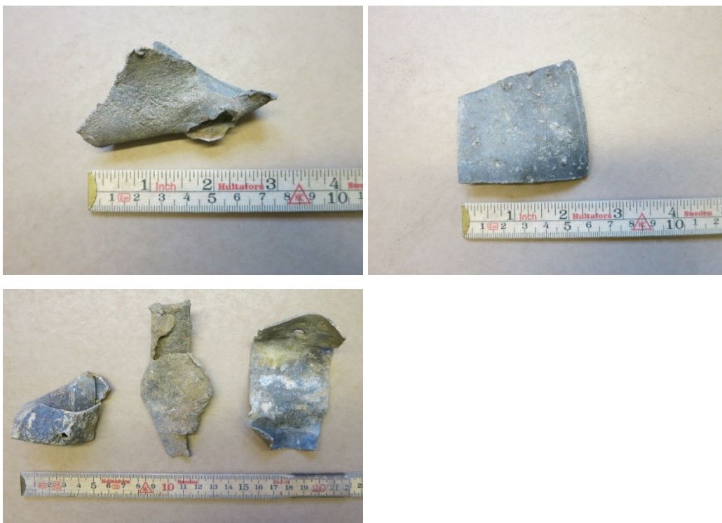
Figur 15. Blyplåten på den vänstra bilden har ett hål där den kan ha varit fastspikad. Blyplåten på den högra bilden, överst, har en rits i ena kanten och kanske var den tänkt att beskäras på den sidan. Blyplåtarna i den understa bilden har hål efter spikning. Foto 2017 ©Kulturen.
